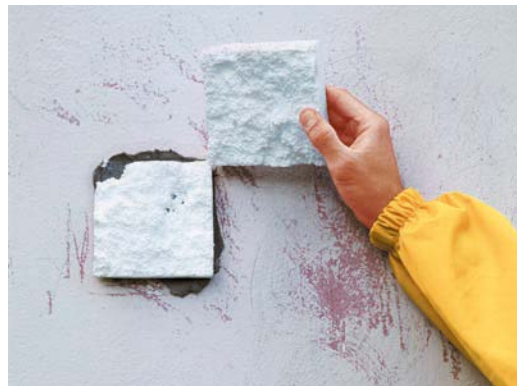
Teine katsemeetod ehk pull-off test
